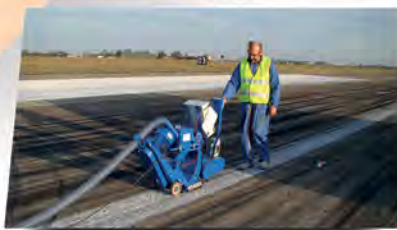
ДРОБЕСТРУЙНЫЕ МАШИНЫ ДЛЯ ОЧИСТКИ ПОВЕРХНОСТИ И НАНЕСЕНИЯ ТЕКСТУРЫ НА АСФАЛЬТЕ И БЕТОНЕ
