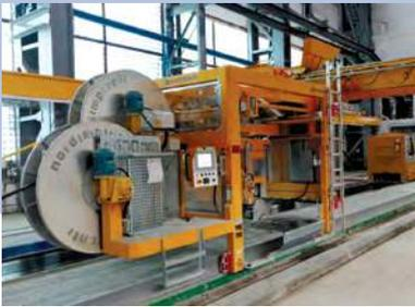
Планетарный бетоносмеситель XENTRIX 2500 компании SIMEM производит жесткие бетоны с водоцементным соотношением 0,28-0,32, с выгрузкой в ковш, адресной подачей 1700/2500 л и доставкой бетона в распределительный мост загрузки экструдера. Распределительный мост работает по 7 дорожкам. Экструдер подключен к троллею распределительного моста. Заказ, производство и доставка бетонной смеси реализуется микропроцессорной системой управления SIMEM посредством беспроводной связи Wi-Fi.
